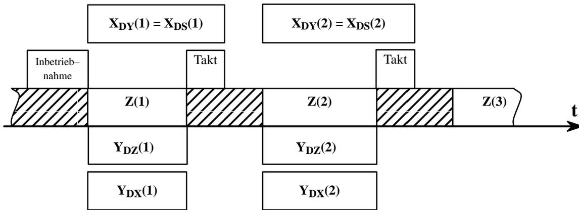
**Bild 6** Der Verlauf der Ein- und Ausgaberscheinungen des "Mealy-Schaltwerks"
