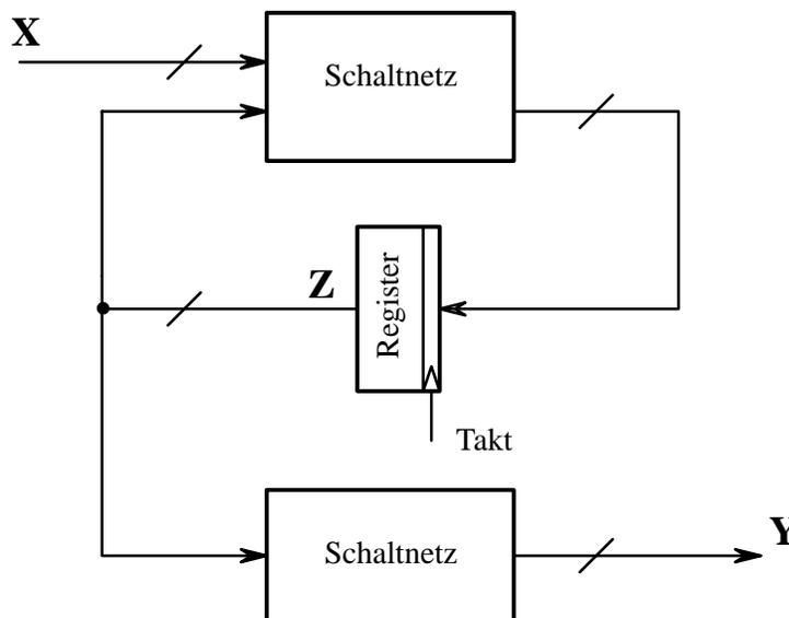
**Bild 4** Blockschaltbild eines "Moore-Schaltwerks"
