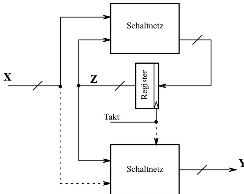
**Bild 8** Blockschaltbild eines Schaltwerks, anhand dessen McCluskey den Unterschied zwischen den Schaltwerkstypen von Moore und Mealy definiert
