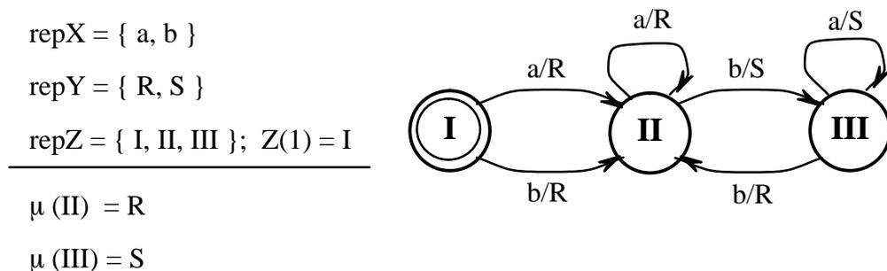
**Bild 10** Beispiel eines Pseudo-Moore-Automatenmodells, bei dem der Definitionsbereich der Funktion  $\mu$  nicht gleich  $\text{rep}Z$  ist
