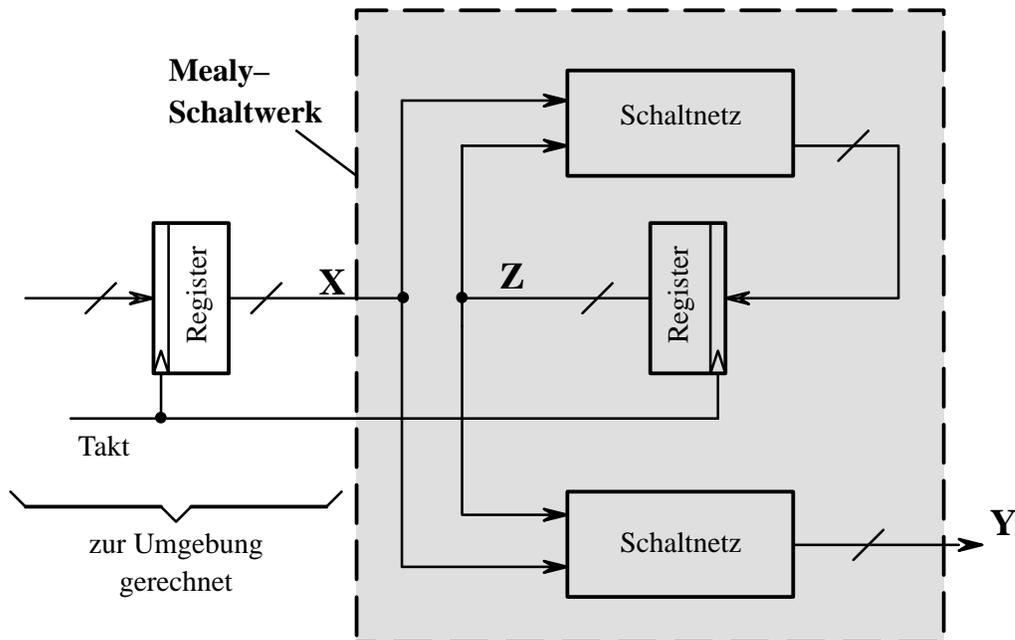
**Bild 5** Blockschaltbild des "Mealy-Schaltwerks"
