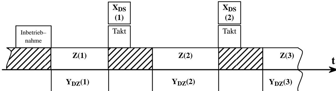
**Bild 3** Der Verlauf der Ein- und Ausgabeerscheinungen einer "Moore-Maschine"
