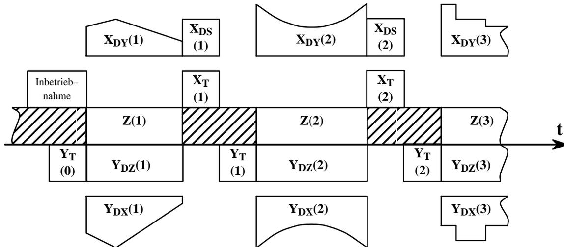
**Bild 2** Die verschiedenen Arten von Ein- und Ausgabeerscheinungen beim Betrieb einer sequentiellen Maschine
